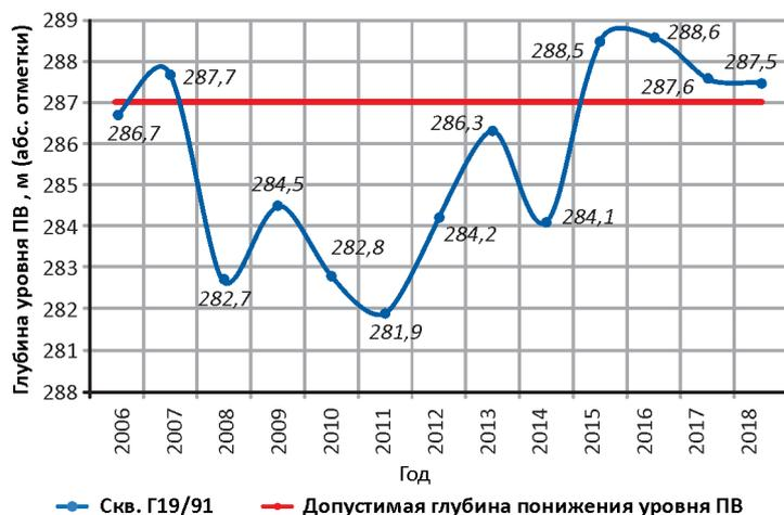
Рис. 1.33 Динамика изменения уровня подземных вод на Майминском водозаборе в 2006–2018 гг.
