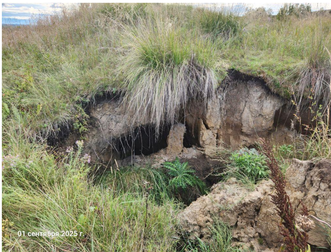
Фото 24-17-00005. Суффозионный провал №2 с суффозионными каналами в борту, ПН уч. а/дороги Анцирь – Хаерино, в 0,5 км З с. Анцирь, Канский район, Красноярский край, 01.09.2025
